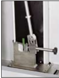
Izod Impact Test Configuration
